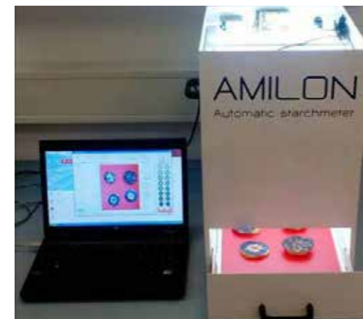
Fig. 2: Risultati della misurazione digitale di amido con lo strumento "Amilon"
