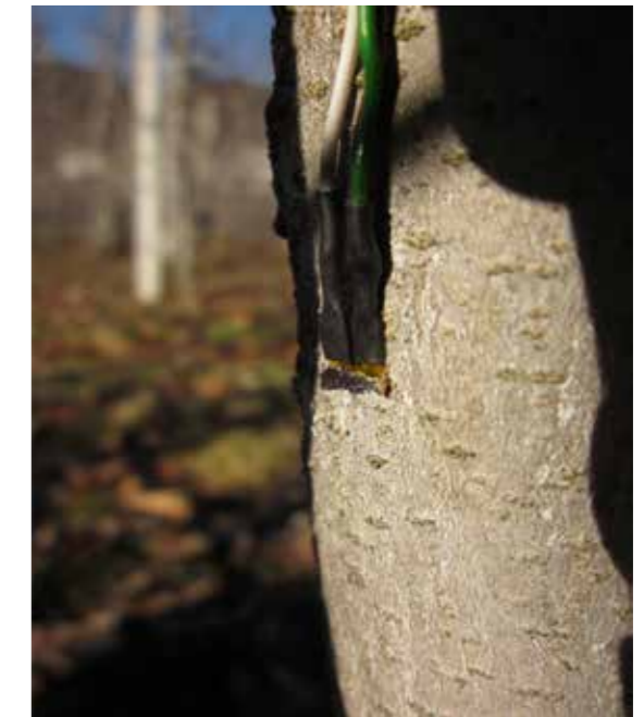
Fig. 1: Un sensore di temperatura prima (sinistra) e dopo (destra) l'inserimento sotto la corteccia. La freccia indica il punto esatto di misurazione.
