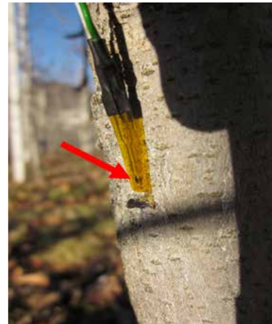
Fig. 1: Un sensore di temperatura prima (sinistra) e dopo (destra) l'inserimento sotto la corteccia. La freccia indica il punto esatto di misurazione.
