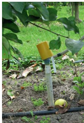
Kontinuierliche Messung der Wasserverfügbarkeit durch elektronische Tensiometer
