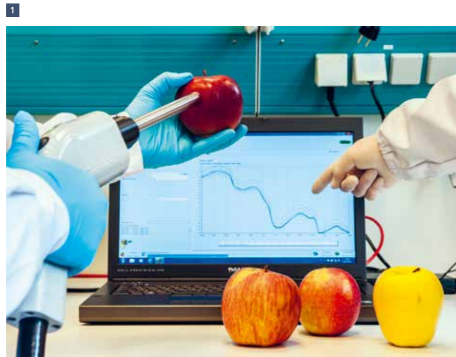
Abb. 1: Nahinfrarot-Spektren an Äpfeln, die von einer fiberoptischen Sonde im Wellenbereich von 1.000 bis 2.500 nm aufgenommen wurden
