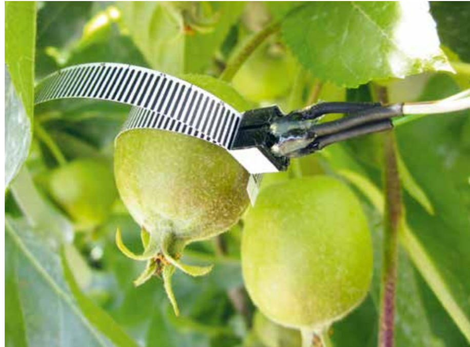
Abb. 1: Der neue Frucht- wachstumssensor an einem jungen Apfel
